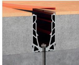
Elemento temporal aplicado como protección al perfil para evitar la entrada de áridos durante las fases de terminación de la obra.
